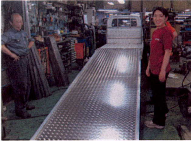
①軽トラックの荷台にスロープがついた新しい騎乗台 ②従来のビールケースは安定せず、転落の危険もあった(ナナの家提供)
