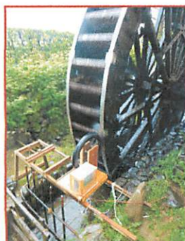
自作発電機による水力発電の様子。50個のLED電球点灯。
